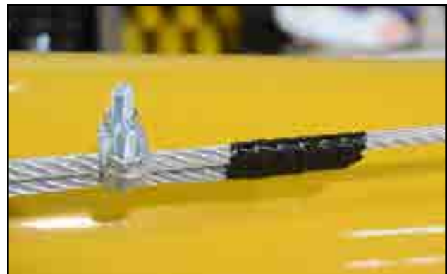
Fig 171 - Wrap cable ends
